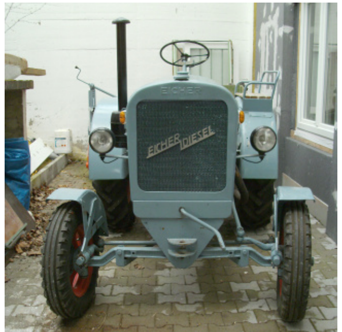
9 Eicher wassergekühlt, Deutz-Motor, 22 PS, ZF-Getriebe, Baujahr 1949, optisch o.K. aber Motor defekt
