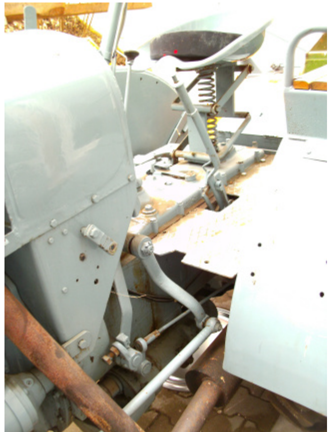
10 Eicher wassergekühlt, Deutz-Motor, 22 PS, Prometheus Getriebe, Baujahr 1939, unrestauriert, stark restaurierungsbedürftig
